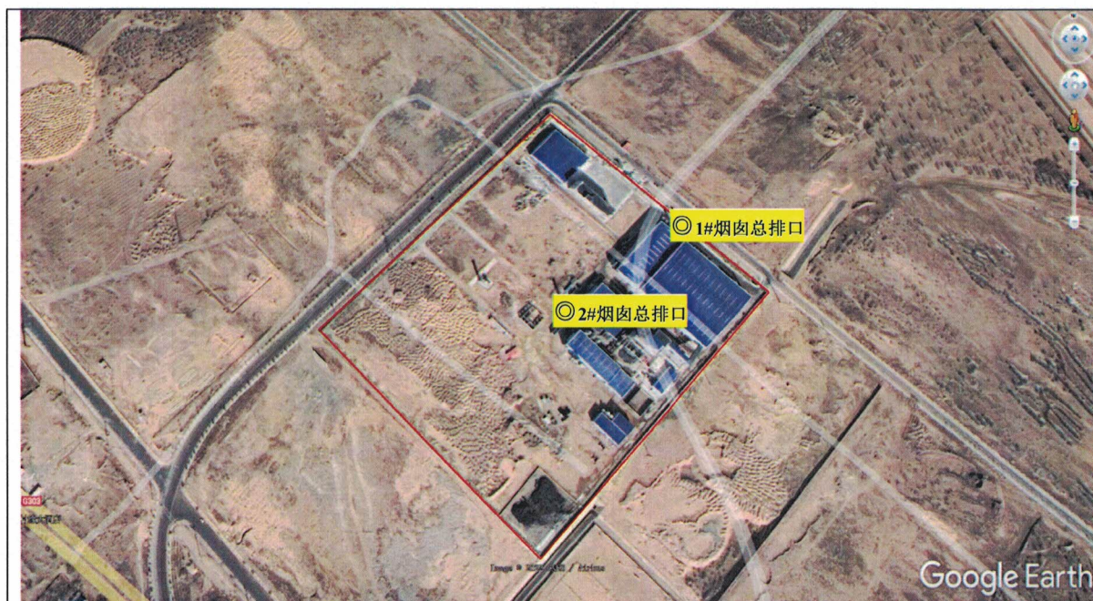
废气污染源采样点位示意图
